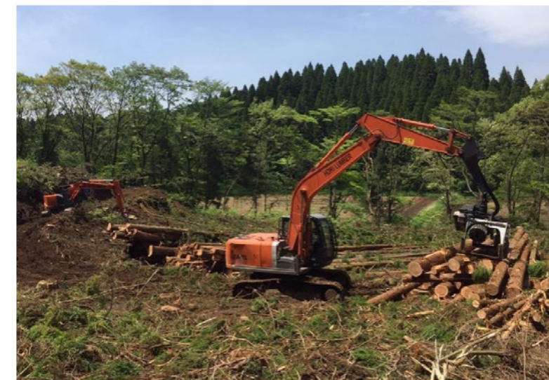
アームの先に木を掴む装置がついた「グラブブル」。装備しているカッターで丸太を作る。道をふさぐ木を処理したり、災害にも駆けつけ活躍する重機だ
