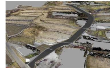
ドローンで解析した三次元データに道路計画を合成した図
