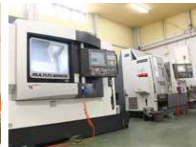
昨年導入した複合旋盤加工機。右奥の機械が創業時に設備投資した旋盤。
