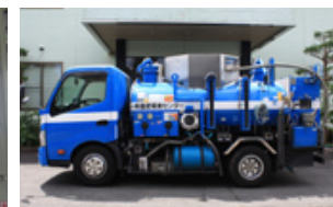
浄化槽掃除の際に吸引したものを車中で清水分離し、あまった水は汚水として戻す「汚泥濃縮車」。汚泥の減量化や浄化槽汚水の節約になる
